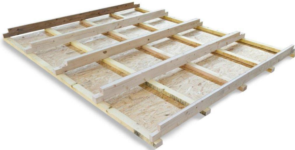
Das Grundmodul, wie auf der Konterlattung montiert, wird in einem Rastermaß von 600 mm quer miteinander unter Berücksichtigung genügend seitlicher Überstände verschraubt. Die Elemente werden in der Höhe in einen Raster von 2000mm in Reihe verlegt so wie es die Fläche zu lässt.
